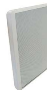
2 pásmový reproduktor pro povrchovou montáž 5" - 32 Ω - rozměry (mm): 274 x 185 x 37 - maximální výkon: 15 W - frekvenční rozsah: 80-19000 Hz
