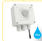
TEV-3 Termostat pro regulaci vytápění (chlazení), nastavitelný rozsah 5 až +35 °C, externí senzor NTC, výstupní kontakt 16 A, ovládací potenciometr a indikace na panelu. str. 139
